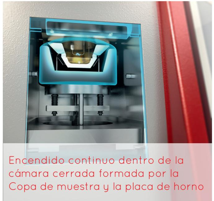
Encendido continuo dentro de la cámara cerrada formada por la Copa de muestra y la placa de horno
